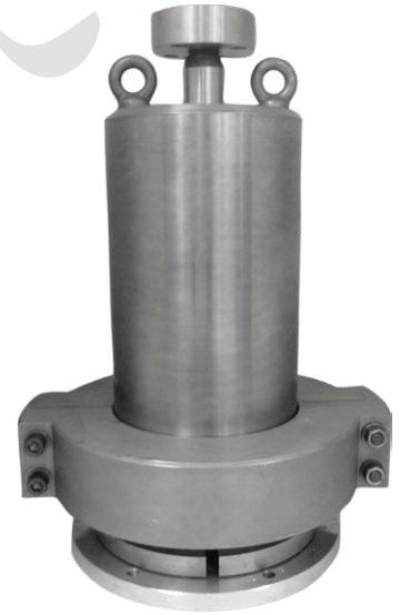
100MPa 三轴压力室, 适用试样直径最大 50mm (HP100MPA)
