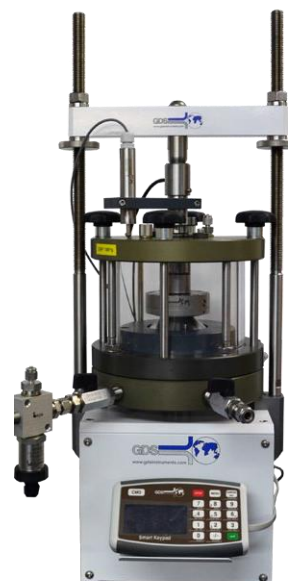
恒应变速率 (CRS) 试验带反压
