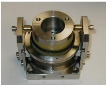
图10 试样上方的顶帽
