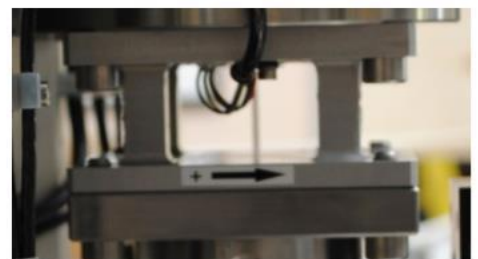
图6 作用在试样上的剪切荷重传感器
