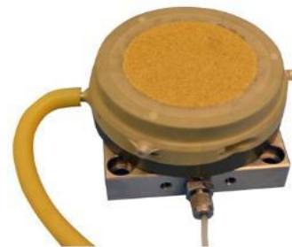
图11 在真空制样装置中制备的非粘性土
